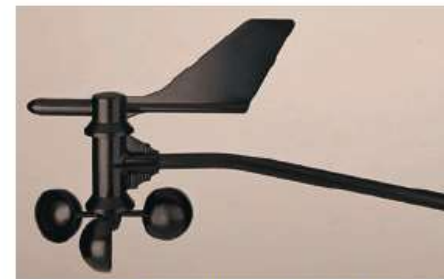
Sensor automático de baixo custo – mede a direção e velocidade do vento
