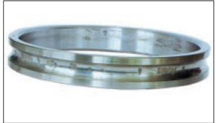
**Componente:** Anel interno de rolamento de contato angular.
