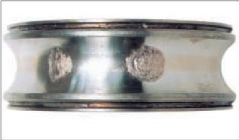
**Componente:** Anel interno de rolamento fixo de uma carreira de esferas.
