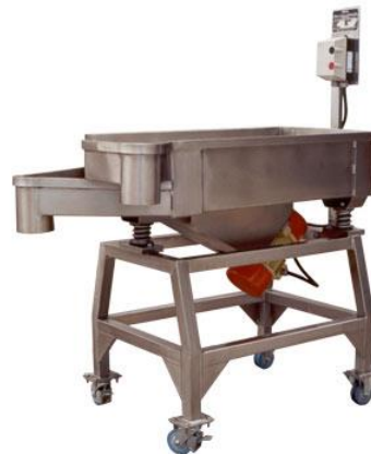
Peneiras vibratórias de planta piloto ou pequena indústria
