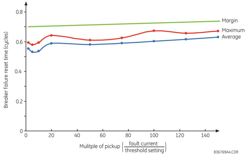
Figure 5-76: BREAKER FAILURE OVERCURRENT SUPERVISION RESET TIME
