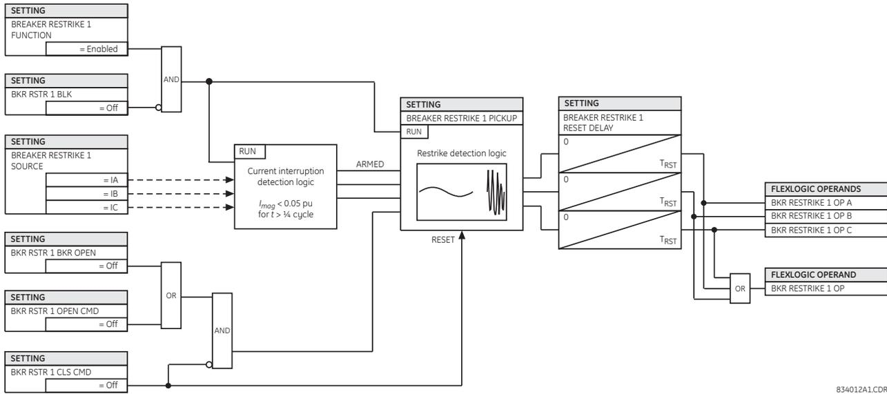
Figure 5–114: BREAKER RESTRIKE SCHEME LOGIC
