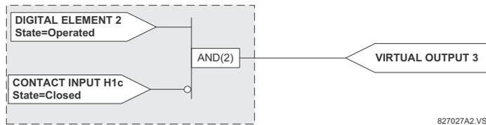
Figure 5-45: LOGIC FOR VIRTUAL OUTPUT 3
