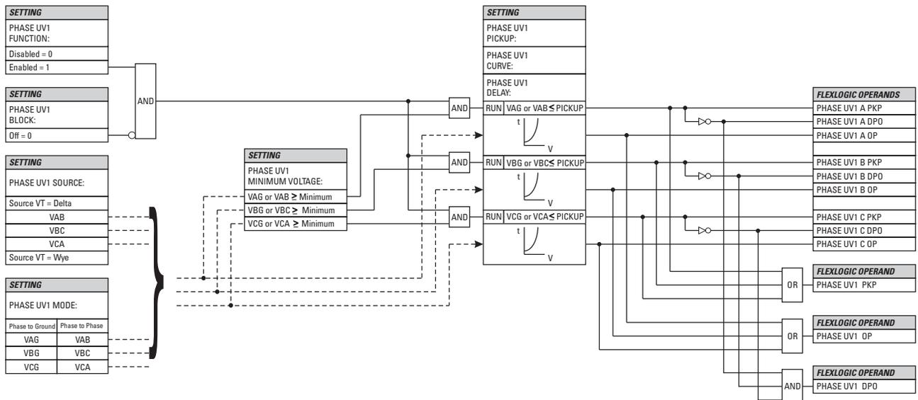
Figure 5–82: PHASE UNDERVOLTAGE1 SCHEME LOGIC
