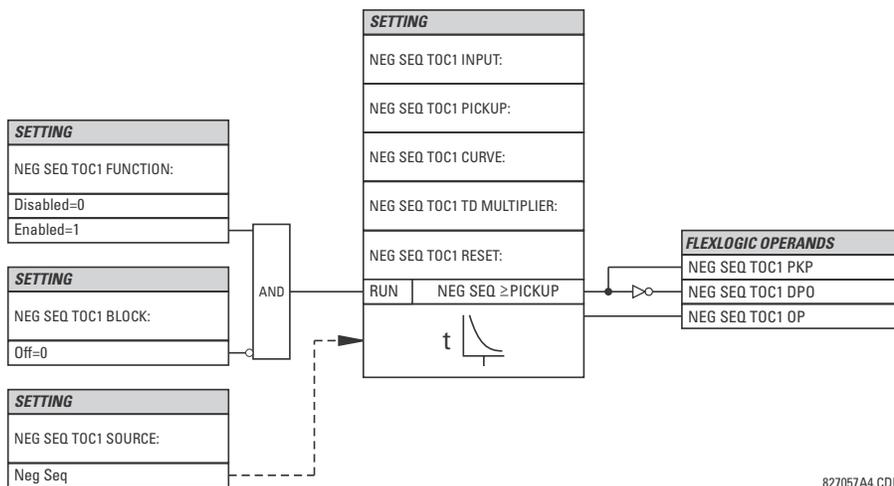
**Figure 5-71: NEGATIVE SEQUENCE TOC1 SCHEME LOGIC**
