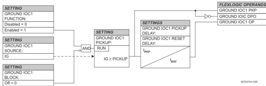
Figure 5-70: GROUND IOC1 SCHEME LOGIC
