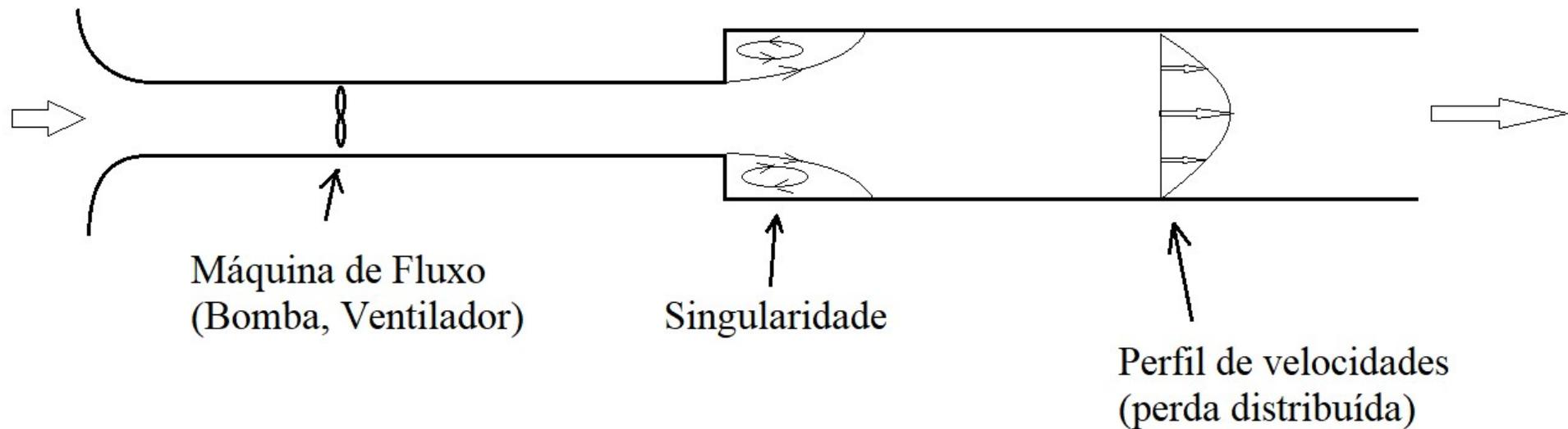
Os gradientes de velocidade do perfil desenvolvido nos trechos retos do conduto causam o aparecimento de tensões viscosas que provocam dissipação de energia mecânica na forma de calor.
