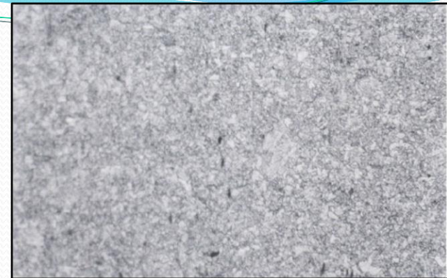
Microestrutura de martensita revenida e áreas de ferrita. Aumento 100X – Ataque: Nital 3%
