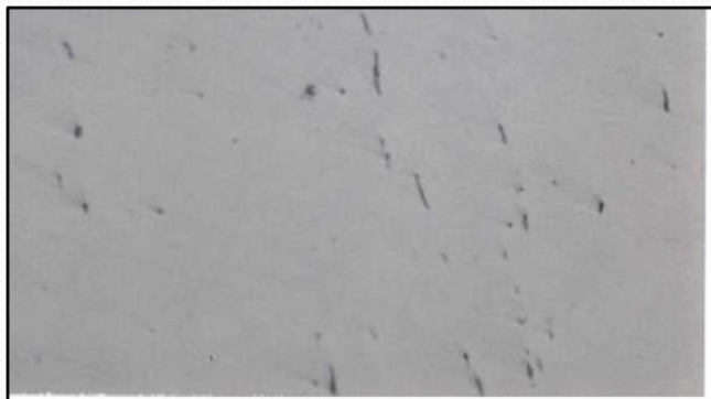
Microinclusões tipo C, série fina, nível 3 e tipo D série fina, nível 2, conforme ASTM E 45.
