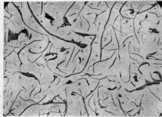
Fig. 534 — Ferro fundido cinzento, sem ataque, com veios do tipo A. 150x.
