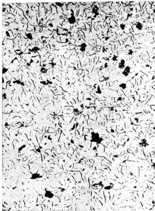
Fig. 548 — Ferro fundido cinzento sem ataque.
