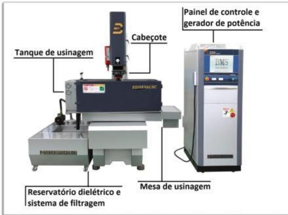
Peça e eletrodo são mergulhados num recipiente que contém um fluido isolante, isto é, não condutor de eletricidade, chamado dielétrico. Em geral, são utilizados como dielétricos o óleo mineral e o querosene. O querosene requer cuidados especiais, pois é inflamável e exala um odor forte, prejudicial à saúde e ao ambiente.
