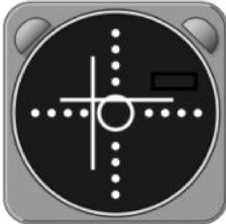
Figura 15 – Instrumento Analógico Básico para ILS
