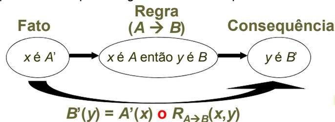
Onde: " $\circ$ " indica uma operação de composição Max-Min, e  $R_{A \rightarrow B}$  é uma função de implicação.
