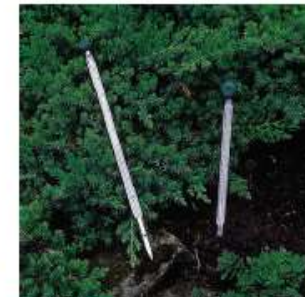
Além dos geotermômetros padrões, existem outros tipos de geotermômetros de baixo custo, para uso em plantações.
