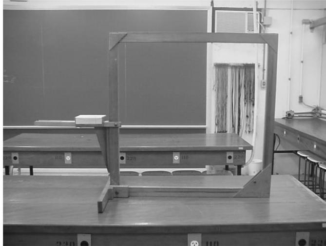
Figura 14 – Bobina quadrada utilizada no experimento de Lei de Ampère;
