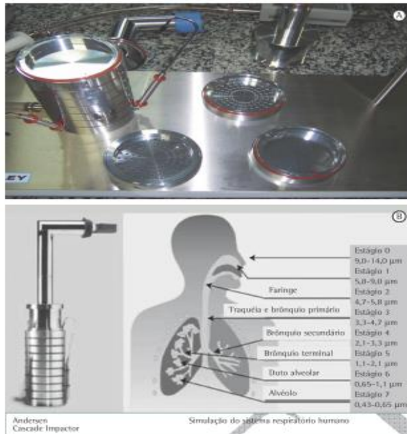
Figura 2 - Em A, imagem do impactador em cascata Andersen, que simula a distribuição aerodinâmica de partículas no sistema respiratório humano. Em B, o aparelho montado e seus estágios equivalentes às diferentes partes do sistema respiratório.
