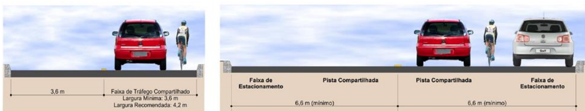
Figura 26: Concepção típica de vias com faixas de tráfego compartilhado. Na esquerda, sem faixa de estacionamento, na direita, com faixa de estacionamento
