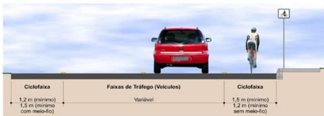
Figura 27: Concepção típica de vias com ciclofaixas
