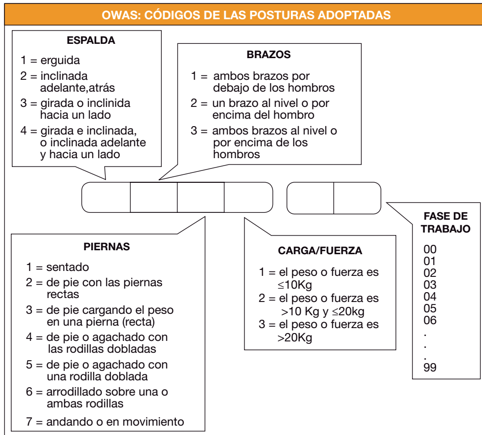
Figura 5. Códigos para el registro de las posturas y de la carga o fuerza realizada
