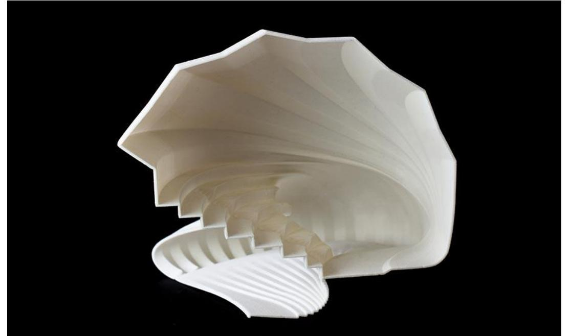
O Polybrick de Jenny Sabin serve projeto de sistema de alvenaria sem argamassa , derivado de desenho algorítmico e tijolos com treliça estrutural mais ou menos densa, de acordo com a carga a ser suportada.
