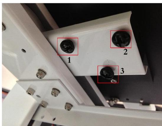
Solte um parafuso e o canto relacionado da plataforma irá subir. Apertar ou afrouxar os parafusos até que você tenha a mesma diferença entre o bico e a plataforma em todos os quatro cantos da plataforma.
