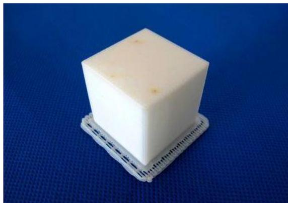
Modelo: 30x30x30 mm - espessuras da camada: 0.2mm
