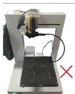
Tenha certeza de que o cabo não fique no caminho da plataforma. Conecte o cabo sempre passando por fora da impressora.
