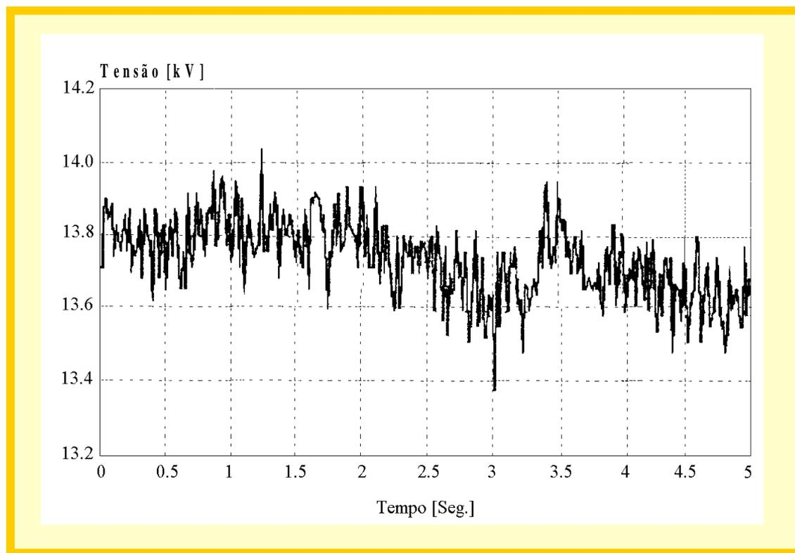
Flutuação de tensão oriundas da operação de um laminador
