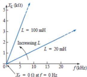
Fig. 9:  $X_L$  em função da frequência.
