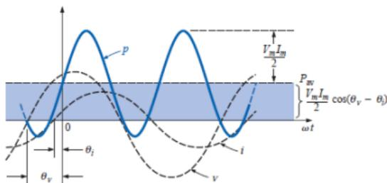
Determinação da potência média de um circuito de corrente alternada senoidal.
