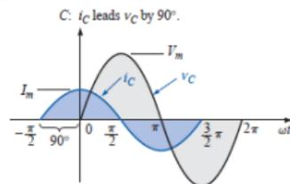
Fig. 6: Para um capacitor puro a corrente está adiantada  $90^\circ$  em relação à tensão.
