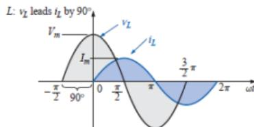
Fig. 4: Para um indutor puro a **tensão está adiantada 90° em relação à corrente.**
