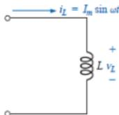
Fig. 3: Resposta de um dispositivo indutivo a uma corrente senoidal.
