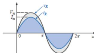
Fig. 2: Em um dispositivo resistivo a **tensão e a corrente estão em fase**.
