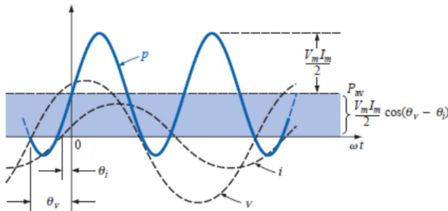
Fig. 11: Determinação da potência média de um circuito de corrente alternada senoidal.
