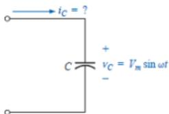
Resposta de um dispositivo capacitivo a uma corrente senoidal.
