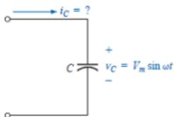
Fig. 5: Resposta de um dispositivo capacitivo a uma corrente senoidal.
