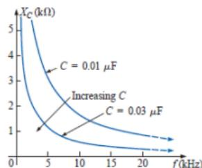
Fig. 10:  $X_C$  em função da frequência.
