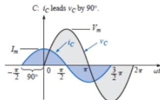
Para um capacitor puro a **corrente está adiantada  $90^\circ$  em relação à tensão.**
