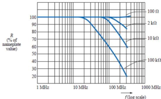
Fig. 7: Curvas de variação da resistência com a frequência para resistores de carbono.
