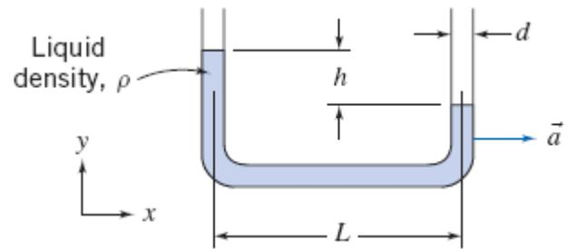
**Given:** U-tube accelerometer
