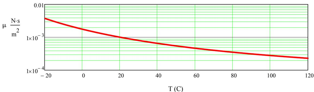
For the flow rate  $\text{Re}_{\text{crit}} = \frac{\rho \cdot V_{\text{crit}} \cdot D}{\mu} = \frac{\rho \cdot Q_{\text{max}} \cdot D}{\mu \cdot \frac{\pi}{4} \cdot D^2} = \frac{4 \cdot \rho \cdot Q_{\text{max}}}{\mu \cdot \pi \cdot D}$   $Q_{\text{max}}(T) = \frac{\pi \cdot \mu(T) \cdot D \cdot \text{Re}_{\text{crit}}}{4 \cdot \rho}$
