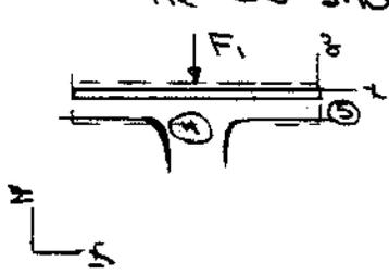
$$F_{sz} + \Delta \dot{p}_z = \frac{\partial}{\partial t} \int_{CV} w_{zsz} \rho dV + \int_{CS} w_{zsz} (\rho \vec{V}_{zsz} \cdot d\vec{A})$$
