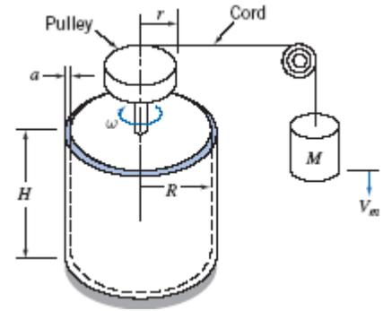
**Given:** Data on the viscometer
