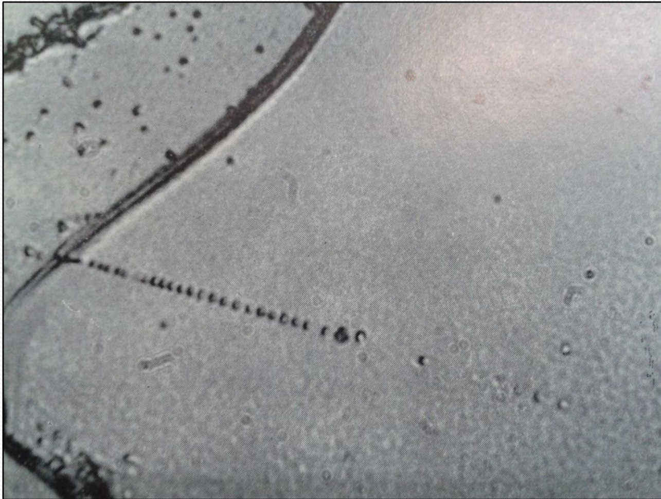
PILE UP EM TRINCA INTERGRANULAR (LATÃO ALFA)
