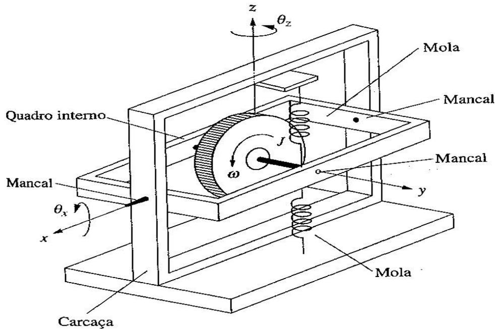
Os giroscópios são usados em veículos espaciais, aviões, navios e submarinos para fazer navegação inercial. O giroscópio ilustrado na figura é um girômetro cujo movimento angular do quadro interno é restringido por meio das molas ilustradas de rigidez  $K$ . Admita ainda que há atrito viscoso com coeficiente de amortecimento  $B$  nos mancais. Como sabemos, uma velocidade angular ao redor do eixo  $z$  faz o rotor precessar ao redor do eixo  $x$ .
