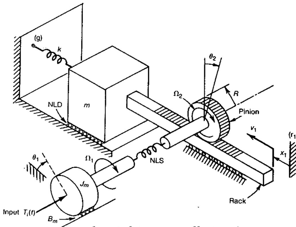
O mecanismo de pinhão-cremalheira é um modelo físico do acionador de uma máquina-ferramenta. O disco de inércia  $J_m$ , representa a inércia de um motor de corrente contínua controlado por uma fonte de tensão ideal  $V_a(t)$  na armadura, produzindo o torque  $T_i(t)$  (ilustrado) que é aplicado ao conjunto. O motor CC, não totalmente ilustrado na figura, tem indutância de armadura  $L$ , e resistência do circuito da armadura  $R$ , sendo o atrito interno  $B_m$  (ilustrado).
