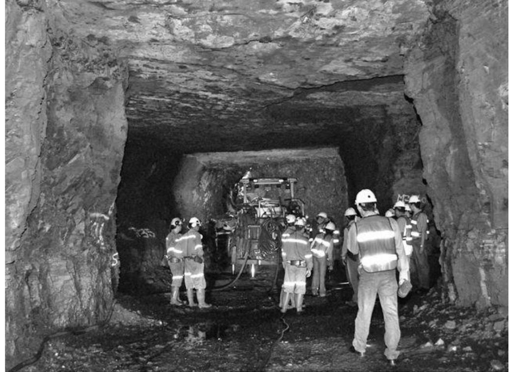
Lavra desenvolvida no subsolo em função de dois condicionantes, um é a geometria do corpo (inclinação e espessura) e o outro são as características de resistência e estabilidade dos maciços que constituem o minério e suas encaixantes.
