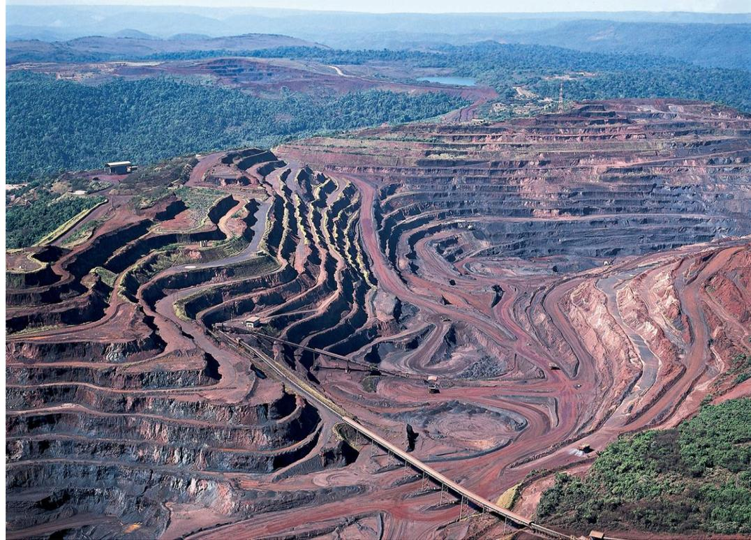
Método de bancos em cava ou encostas dependente das condições topográficas do terreno, onde a profundidade máxima da cava dependerá diretamente do teor e da relação estéril/minério, como também, as dimensões das plataformas de trabalho dependerão da produção e da conveniência dos equipamentos;
