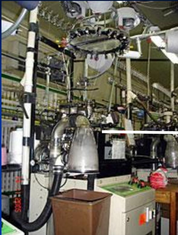
O processo de fabricação do produto “meia”, pode ser considerado contínuo pelo fato, de que, a partir do abastecimento de fio no tear circular o fluxo de material flui automaticamente na confecção da “meia” sem a interferência do operador, até finalizar o produto “meia” no final do processo, descartando o produto pronto.
