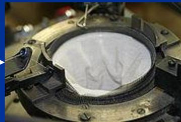
Bocal em que a meia é fabricada no tear a partir do lançamento do fio.
