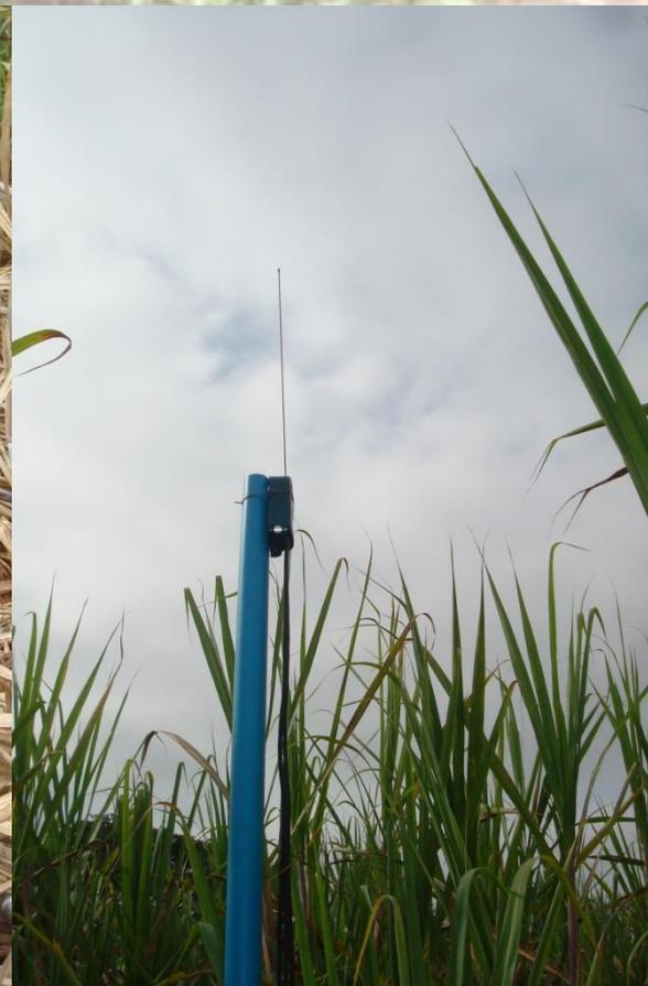
**Tensiômetro via radio**
