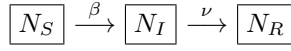
Figura 2.6: Este esquema nos permite escrever: dN_S/dt = -\beta N_S N_I/N , dN_I/dt = \beta N_S N_I/N - \nu N_I e dN_R/dt = \nu N_I .
