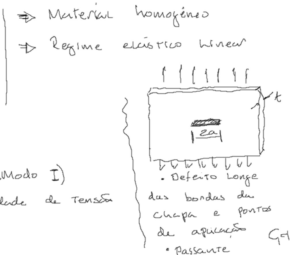
$$K_I = G \sqrt{\pi a} \quad (\text{MPa} \sqrt{\text{m}}) \text{ ou } (\text{MPa} \sqrt{\text{mm}})$$
