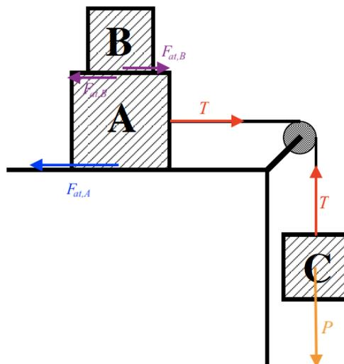
Segundo o diagrama das forças, o peso e a normal dos blocos A e B foram omitidos pois se cancelam, a massa  $m_C$  máxima para que o sistema se movimente em conjunto é tal que a força de atrito sobre o bloco B,  $F_{at,B}$  seja a maior possível, portanto:
