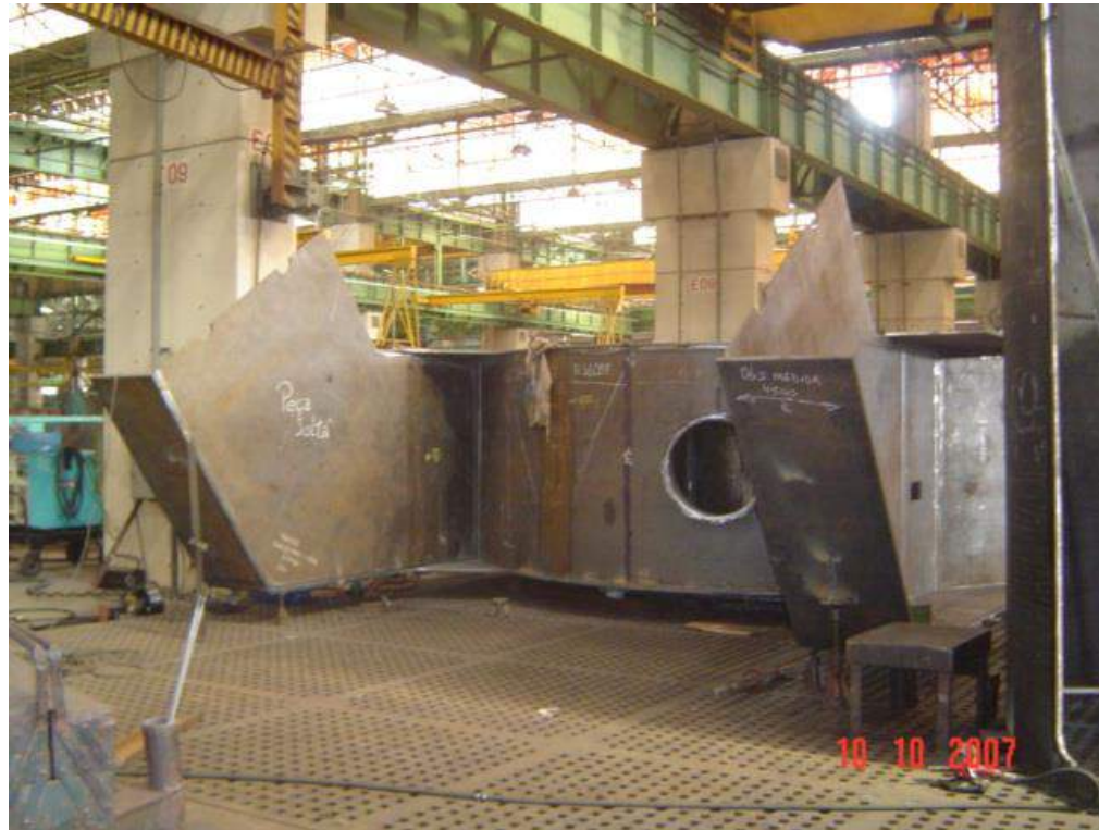
Estrutura Giratória durante a fabricação
