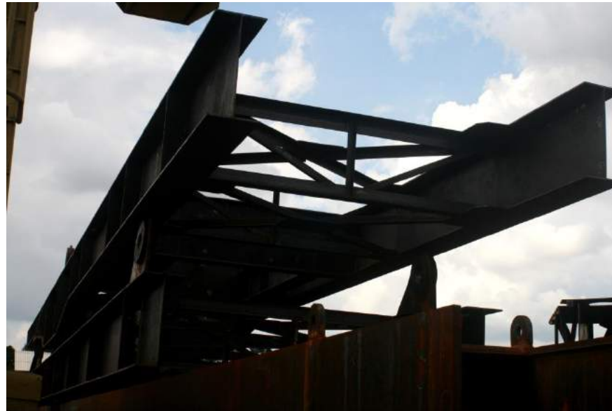
Estrutura da Lança fabricada
