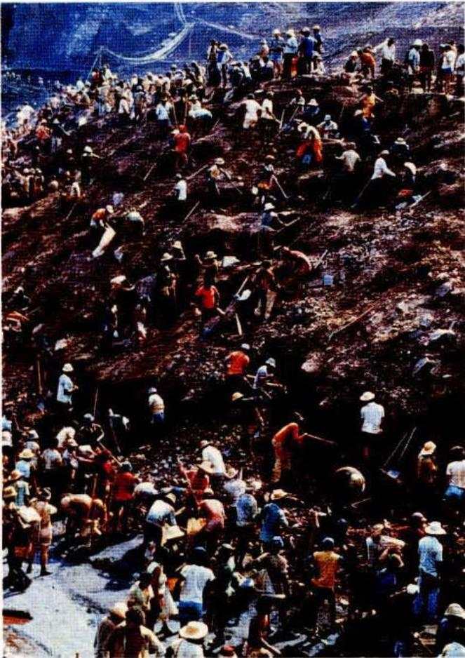
Fig. 21.12 Escavações por meio de trabalho manual rudimentar, utilizando-se ferramentas simples no garimpo de ouro de Serra Pelada (PA), no decorrer de 1982. Foto: E. Ribeiro Filho.
