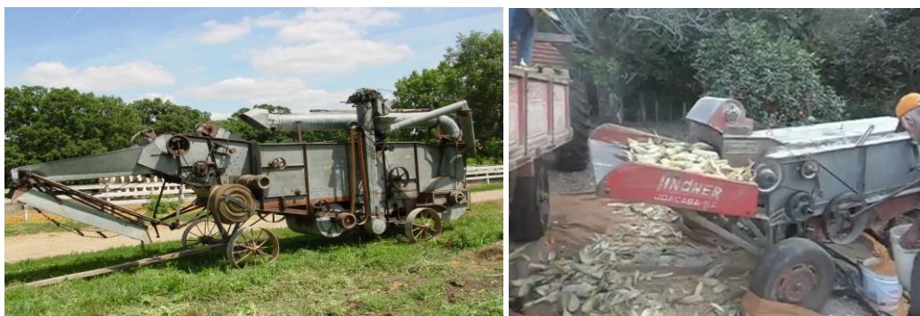
Figura 5. Trilhadoras estacionárias de grande porte, inicialmente acionadas por motor a vapor (esquerda) e de pequeno porte, acionadas por motor estacionário, muito populares no Sul do Brasil, até os anos 1990 (direita)
