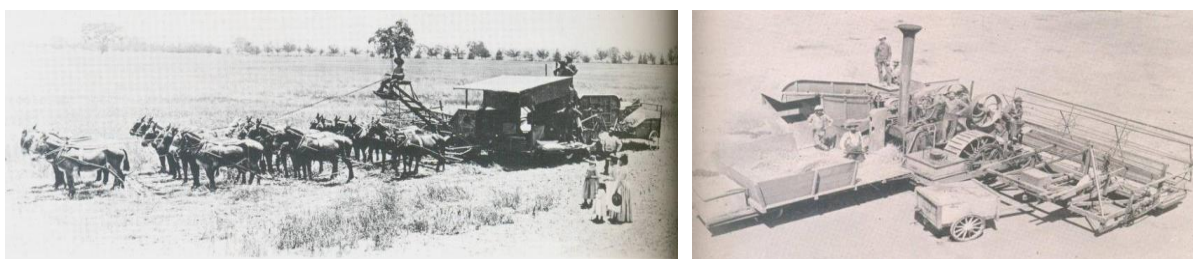
Figura 4. Colhedora combinada de tração animal (esquerda) e acionada por motor a vapor (direita) (QUICK & BUCHELE, 1978).
