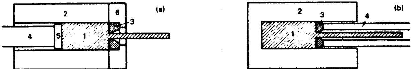
Figura 12.2 - Métodos básicos de extrusão: (a) extrusão direta, (b) Extrusão indireta (retro-extrusão)
