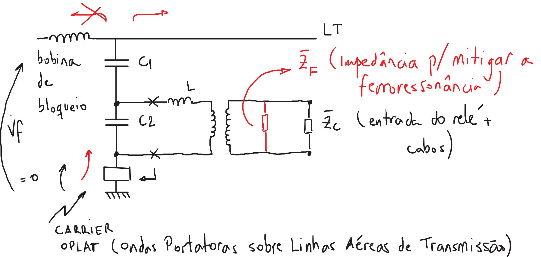
O circuito simplificado (sem considerar a ferroresonância) com o equivalente de Thevenin visto pelos pontos marcados
