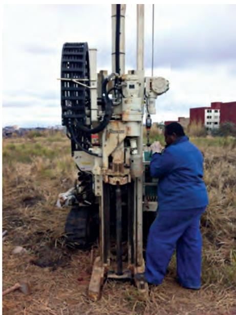
**Figura 4 - GeoHammer portátil – adaptado**
