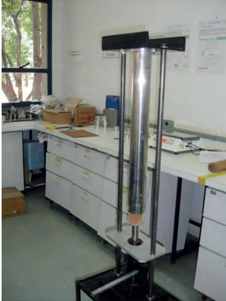
**Figura 11 - Topo do corpo de prova saindo do amostrador Shelby**
