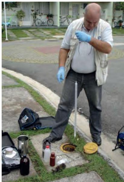
tencial hidrogeniônico (Eh ou ORP), Oxigênio Dissolvido (OD), Sólidos Totais Dissolvidos (STD) temperatura (T°C), turbidez (com turbidímetro) e rebaixamento do nível d'água (NA) com medidor elétrico, os quais devem-se estabilizar antes do início da coleta. A coleta com a bomba só é iniciada quando os parâmetros monitorados se estabilizarem, sendo as variações permitidas apresentadas na Tabela 2.
