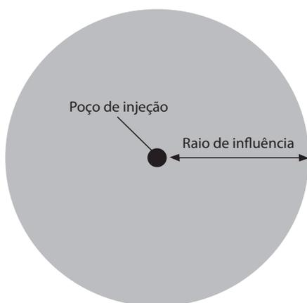
**Figura 7 - Raio de influência de um poço de injeção**
