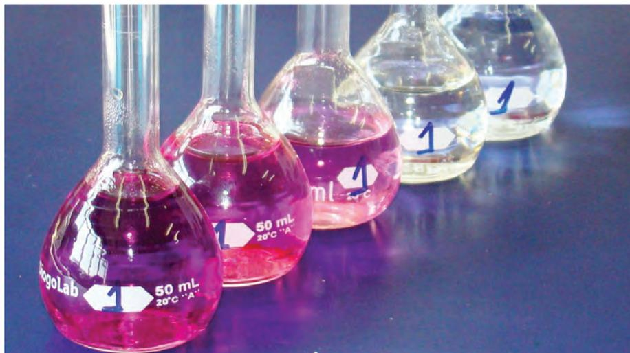
A concentração das soluções pode ser associada à transmitância de luz em determinado comprimento de onda, determinada por equipamento de espectrometria de luz UV-visível.
