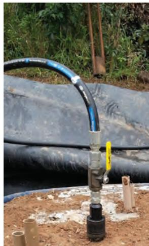
**Figura 15 - Teste piloto com injeção de partículas de ferro em diferentes profundidades**
