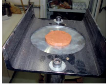
**Figura 12 - Corte do corpo de prova com fio de aço**
