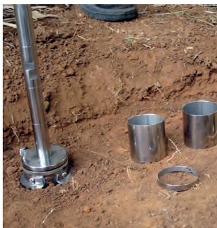
**Figura 9 - Detalhe do amostrador tipo *Uhland* na profundidade de coleta de amostras indeformadas de solo em trincheira**
