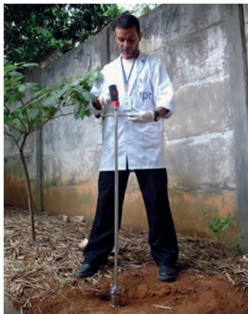
**Figura 8 - Detalhe do amostrador cravado no solo e dos cilindros em aço inox**
