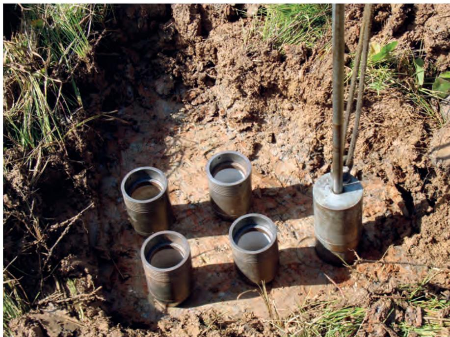
rior do anel principal (Figura 8). Inserir a espátula na parte inferior do cilindro (Figura 9) cortando o solo, e a seguir retira-se ambos empurrando-os com o dedo pelo orifício atrás do compartimento coletor.
