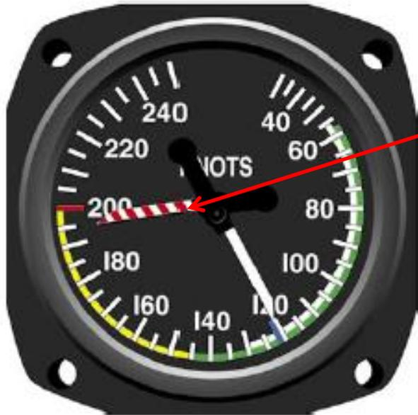
A indicação de máxima velocidade também funciona com um aneróide, pois a máxima velocidade permissível varia com a altitude da aeronave
