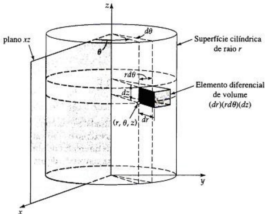
**Fig. A.8-1** Elemento diferencial de volume,  $r dr d\theta dz$ , em coordenadas cilíndricas e elementos diferenciais de linha,  $dr$ ,  $r d\theta$  e  $dz$ . Os elementos diferenciais de superfície são:  $(r d\theta)(dz)$  perpendiculares à direção  $r$  (sombreamento intermediário);  $(dz)(dr)$  perpendiculares à direção  $\theta$  (sombreamento mais escuro) e  $(dr)(r d\theta)$  perpendiculares à direção  $z$  (sombreamento mais leve).
