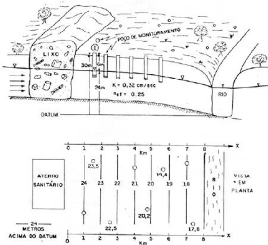
Figura 5.7. Seção transversal e planta para ilustrar um cálculo simplificado do transporte considerando apenas advecção (Cleary, 2007).
