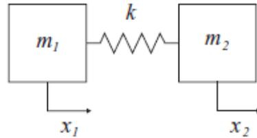
$$\begin{bmatrix} m_1 & 0 \\ 0 & m_2 \end{bmatrix} \begin{Bmatrix} \ddot{x}_1 \\ \ddot{x}_2 \end{Bmatrix} + \begin{bmatrix} k & -k \\ -k & k \end{bmatrix} \begin{Bmatrix} x_1 \\ x_2 \end{Bmatrix} = \begin{Bmatrix} 0 \\ 0 \end{Bmatrix}$$
