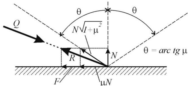
Para uma dada reação normal  $N$ , o valor máximo da força de atrito é  $\mu N$ , o que define uma reação vincular total (resultante) máxima  $N\sqrt{1 + \mu^2}$ , inclinada de um ângulo  $\theta = \text{arctg } \mu$  em relação à normal às superfícies no ponto de contato.
