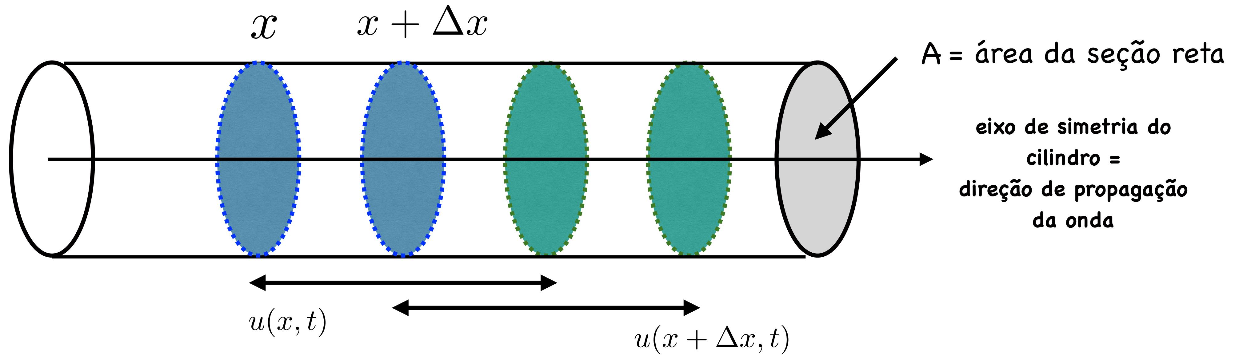
$u(x, t)$  é o deslocamento sofrido pelo fluido na seção transversal de coordenada  $x$  no instante  $t$
