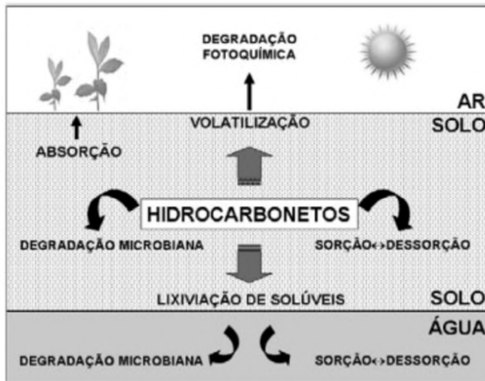
Figura 1. Representação esquemática da dinâmica dos hidrocarbonetos no solo contaminado
