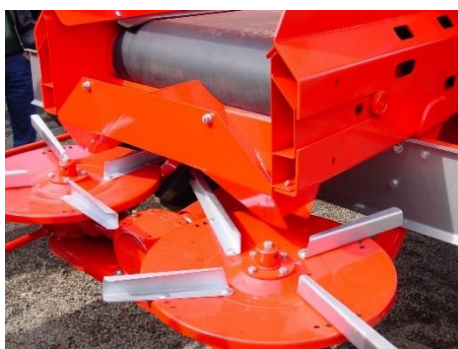
Figura 2 – Mecanismo distribuidor centrífugo de dois discos, com aletas radiais
