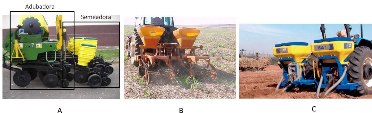
Figura 6 – Aplicador de fertilizantes associado à semeadora de grãos graúdos, de arrasto, com mecanismo dosador helicoidal e deposição em linha (A); associado ao cultivador de cana, montado, com mecanismo dosador helicoidal e deposição em linha (B); associado ao sulcador, montado, com mecanismo dosador helicoidal e deposição em linha (C)
