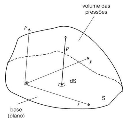
O volume descrito é chamado de “volume das pressões”, e é definido apenas para forças distribuídas paralelas. Como já vimos, este sistema de forças é equivalente a uma única força: a resultante aplicada no centro dessas forças paralelas. Calculando a posição desse ponto pela
