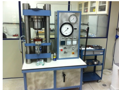
Aparato pistão-cilindro do Laboratório de Petrologia e Geoquímica Experimental (NAP Geoanalítica – IGc-USP)
