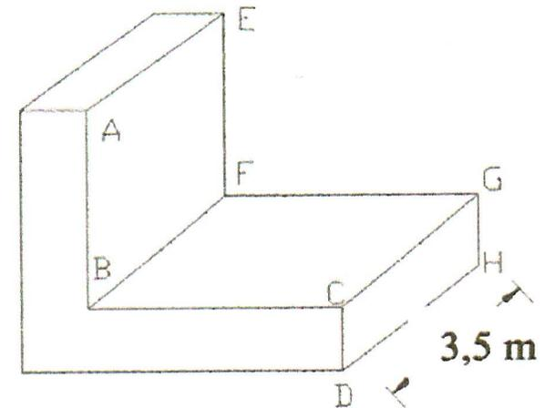
7) Calcular o empuxo sobre o paramento vertical de uma barragem. Sendo 11 m a altura total da água, porém havendo no fundo uma camada de lama, com densidade de 1,5 e 4 m de altura, como mostra a figura abaixo.
