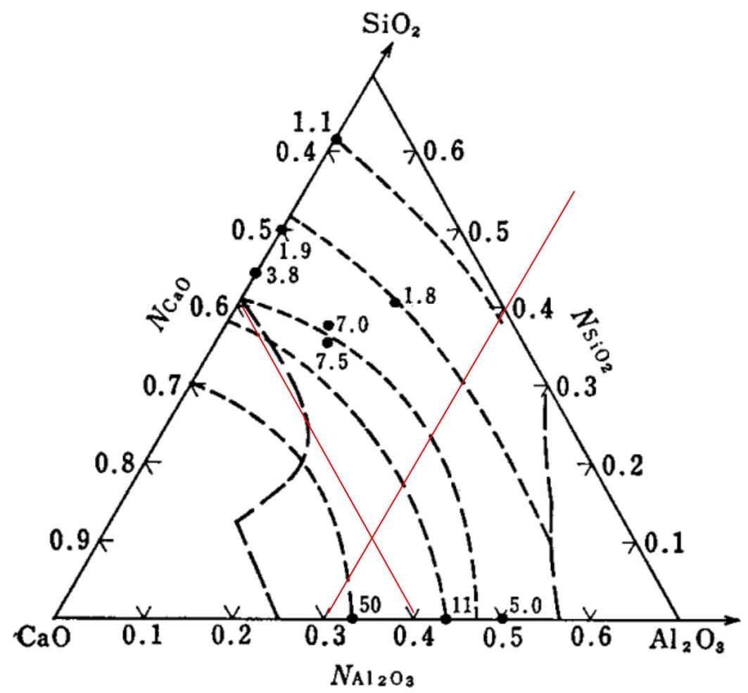
図 1・65 CaO-SiO<sub>2</sub>-Al<sub>2</sub>O<sub>3</sub> 系スラグの sulphide capacity (×10<sup>4</sup>). 1650°C<sup>219)</sup>
