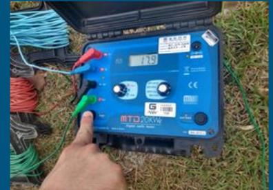
Levantamento de dados de campo para elaboração do projeto, dimensionamento do sistema de proteção catódica, seja por corrente impressa, ou sistemas galvânicos.
