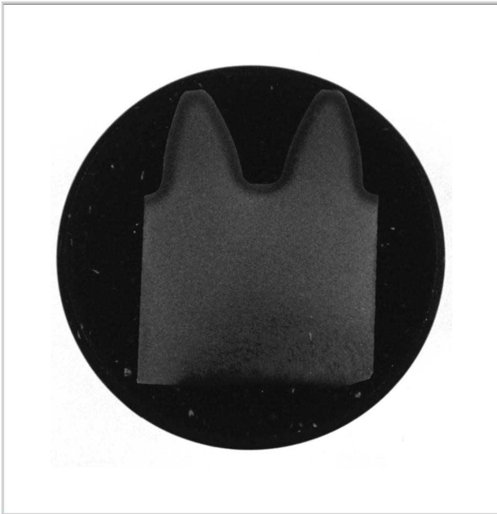
**Figura 4.61** Engrenagem cementada. Nital. 4X.
