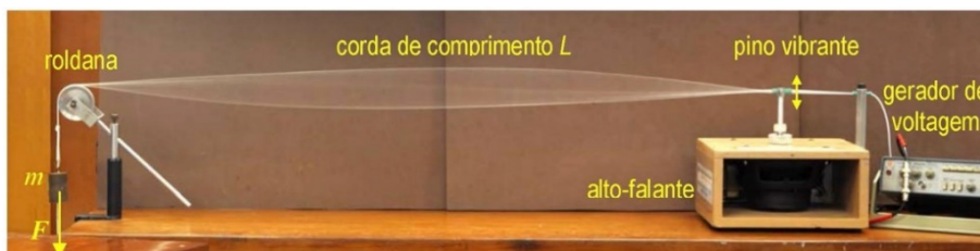
Figura 4.3 - Dispositivo para a geração de ondas estacionárias em uma corda com os extremos presos. Na imagem é mostrada a excitação do modo fundamental ( n = 1 ).
