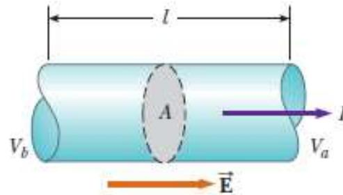
Há uma diferença de potencial  $V_b - V_a$  no condutor, o que provoca um campo elétrico e uma corrente no condutor. Se o campo elétrico for, por hipótese, uniforme, a **diferença de potencial**  $V = V_b - V_a$  estará relacionada com o campo elétrico pela expressão:
