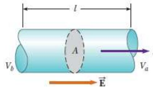
Num condutor, há uma densidade de corrente  $\vec{J}$  e um campo elétrico  $\vec{E}$ , quando se mantém uma diferença de potencial no condutor. Se a diferença de potencial for constante, a corrente no condutor também será constante. Muitas vezes, a densidade de corrente num condutor é proporcional ao campo elétrico no condutor:
